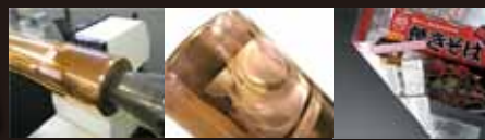
転送されるデジタルカメラから彫金、ダイヤモンドでシリンダーに直接印刷、完成された包装グラビア印刷
